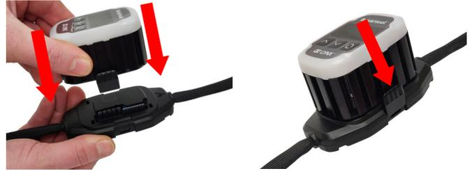
将Lynx模块连接到扩展坞，确保两边的夹子完全啮合。
