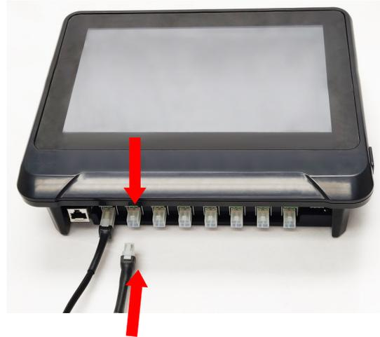
Collegare il primo Dock di ogni stringa al pannello di interfaccia operatore tramite il connettore di comunicazione sul cablaggio di alimentazione. È possibile utilizzare una qualsiasi delle porte di ingresso disponibili (1-8). Assicurarsi che tutti i connettori del cablaggio siano completamente e correttamente inseriti.
